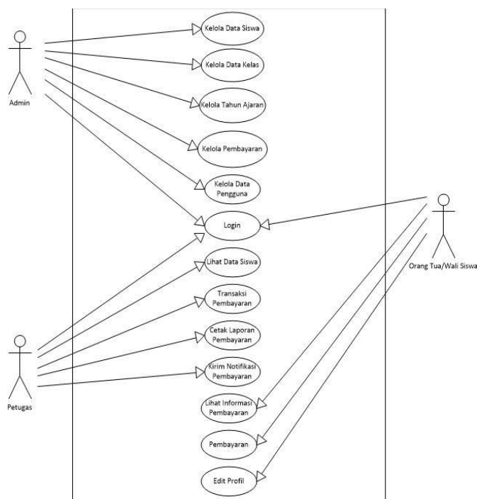
Gambar 3 Use Case Diagram Sistem Pembayaran SPP
